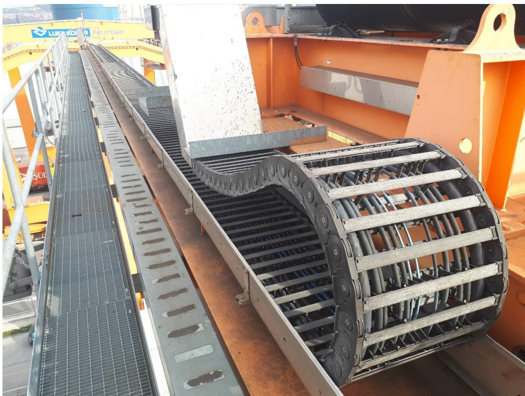
Slika 1: Energijska veriga na RTG dvigalu
